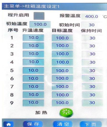
图 3-3 柱箱温度设定 1 程升启用：轻点后面灰色方框，是方框内打上“√”，即可使用程升程序。如图 3-4。
