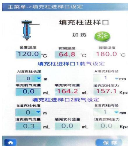
图 3-6 填充柱进样口设定
