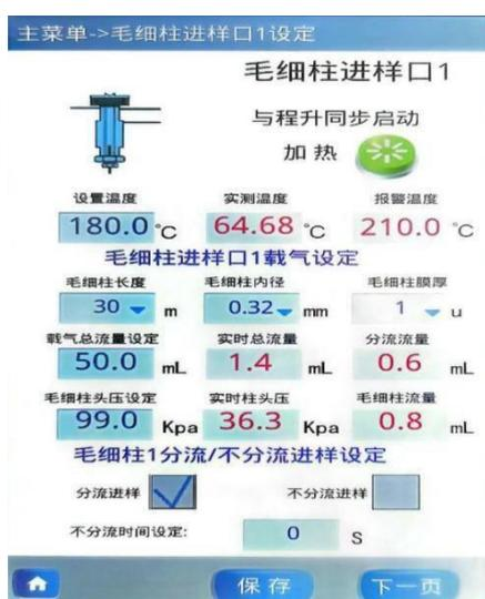
图 3-7 毛细柱进样口 1 设定
