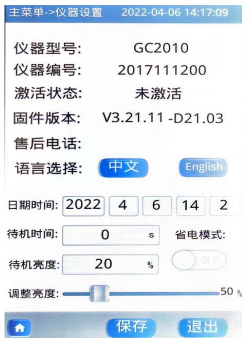
在此界面中可以对仪器的年月日时分秒等时间显示进行设置，按保存键后开始时间运行。也可对屏幕开启省电模式。同时可以观察到仪器的型号、出厂编号、激活状态、售后电话及固件版本。按退出键或者屏幕的左上角的键都可退出本界面回到主界面。
