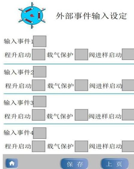
外部事件是解决气相色谱仪在连接了一些外部设备时，这些外部设备和气相色谱仪联动的问题。外部设备可以是自动进样器、热解吸装置、顶空进样器等等。外部事件共有高电平输入和低电平输入二种模式，每种模式又可以连接 2 个设备。高电平模式是指外部设备完成了工作后向气相色谱仪发送一个 5V 至 12V 的电压，气相色谱仪在检测到这个电压后即开始分析工作；低电平模式是指外部设备完成了工作后向气相色谱仪发送一个 0V 的电压，气相色谱仪在检测到这个电压后即开始分析工作，在气相色谱仪上到底是选用高电平还是低电平由外部设备输出的联络信号是高电平还是低电平决定。
